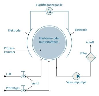
Abb. 2: Niederdruckplasmaanlage
