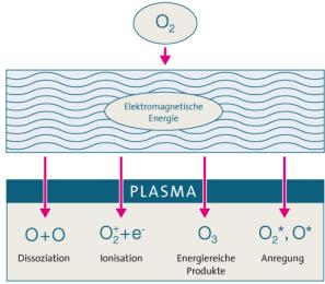
Abbildung 1: Entstehung eines Sauerstoff-Plasmas
