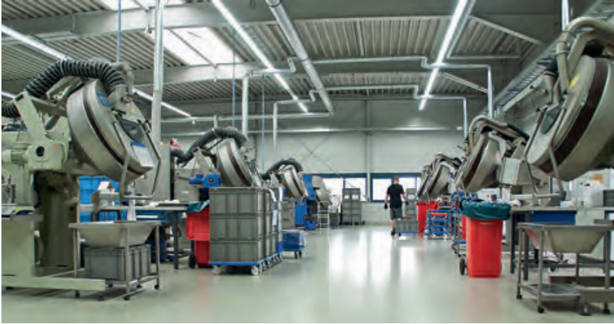
Bild 4: Werden Dichtungen in speziellen Maschinen mit einer Gleitlack-schicht auf Wasserbasis beschichtet, lässt sich die Reibung um durchschnittlich 50% reduzieren
