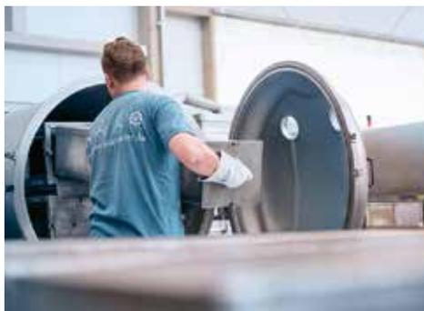
**Bild 2:** Durch die Plasmareinigung und -aktivierung erhöhen sich Adhäsionsfähigkeit und Benetzbarkeit der Oberflächen (Bild: OVE Plasmatec GmbH)
