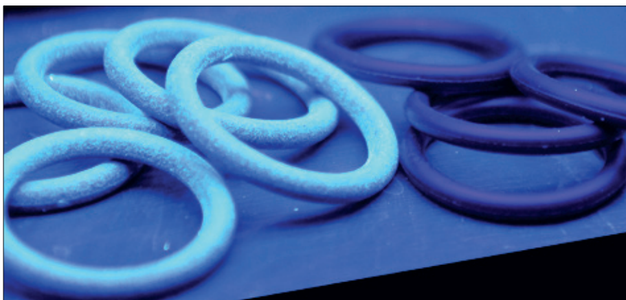
Bild 3: beschichteter (links) und unbeschichteter O-Ring unter UV-Licht.
