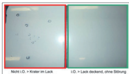
Bild 2: Labstest nach VW PV 3.10.7, Gut-Schlecht-Muster.
