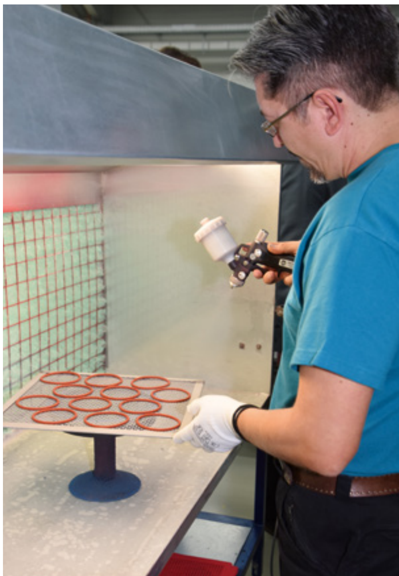
Neben einer automatisierten Fertigung für kleinere Teile wird auch von Hand beschichtet
